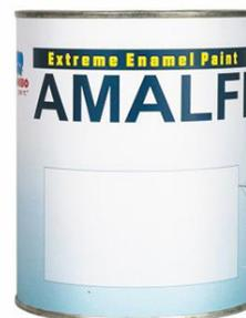
**NOTE TECNICHE**Aggiornata al: **11/24/2021**Resa al Kg: **200 GR MQ**Diluizione: **20% Diluente epossidico**Applicazione: **1 strato**Supporto: **Ferro, Acciaio, Pvc, Laniera zincate**Limite COV: **400**Peso Specifico: **1250**
